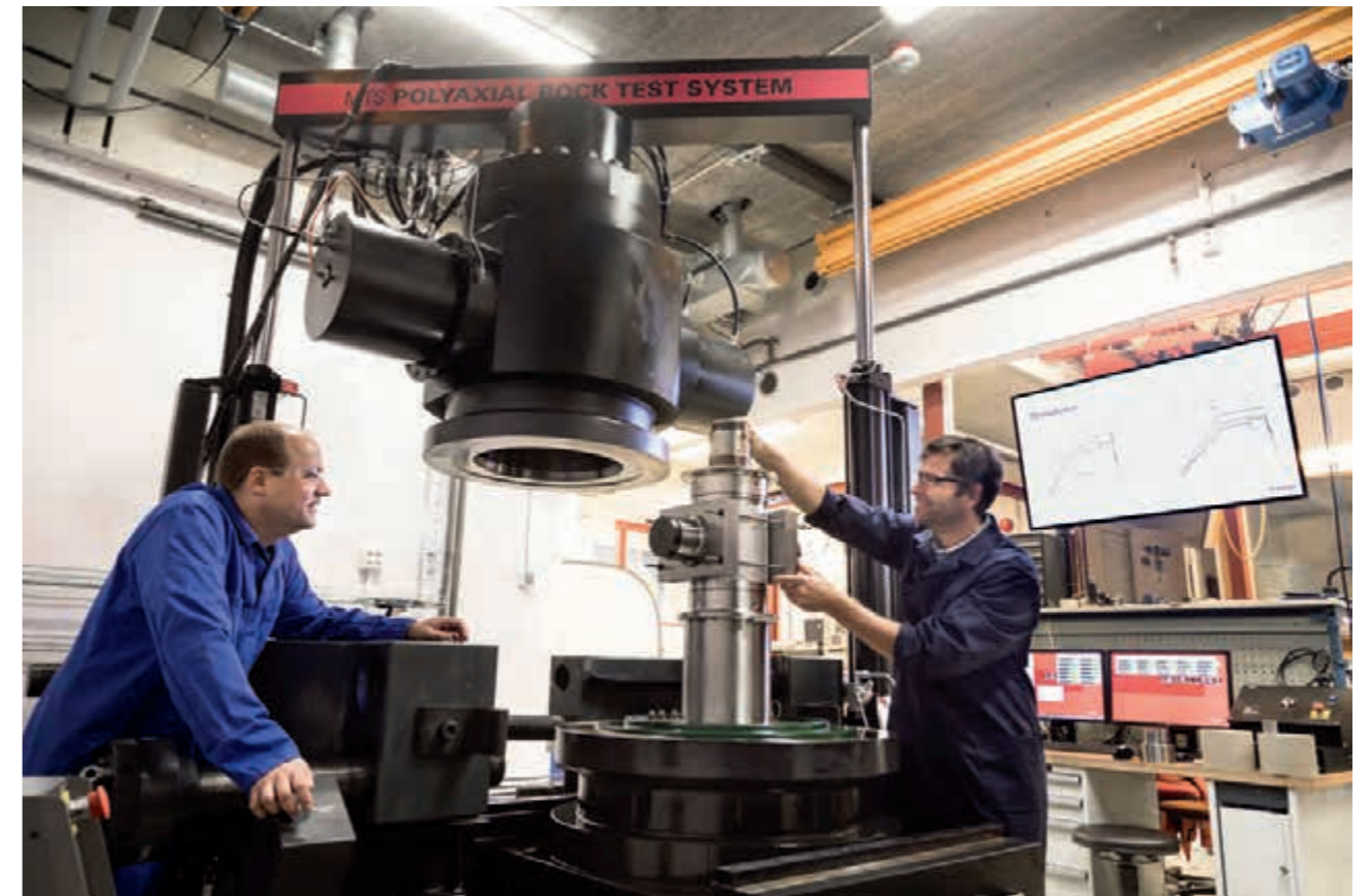
Nedskalerte brønner testes under realistiske trykk- og temperaturbetingelser med det spesialdesignede utstyret. Foto: SINTEF
